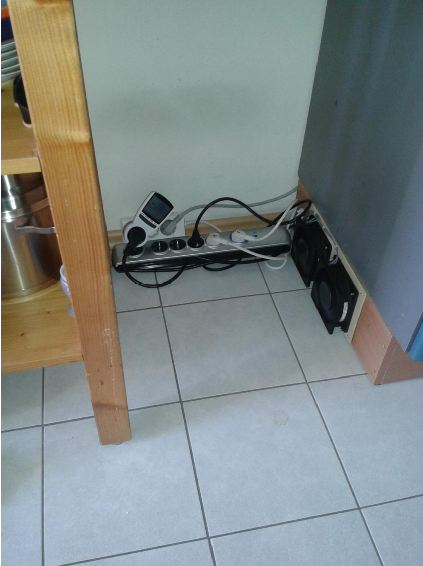
Bild 6: Aufbau mit zusätzlichen Lüftern und Master-Slave Steckdose mit Messgerät
