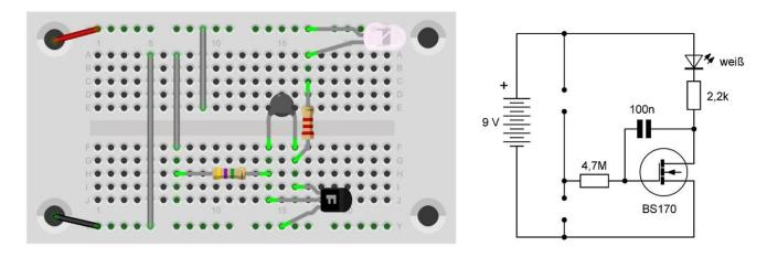
Wenn der obere Kontakt berührt wird, steigt die Spannung am Gate des BS170, und es fließt mehr Strom durch die LED. Gleichzeitig sinkt aber die Spannung am Drain, sodass der Kondensator zwischen Gate und Drain der Änderung entgegenwirkt. Die Veränderung der Helligkeit wird dadurch verlangsamt. Zugleich sorgt der Kondensator dafür, dass die eingestellte Helligkeit sehr lange unverändert erhalten bleibt.
